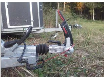
Nach diesem Erlebnis ersetzte ich die verbaute Kupplung durch eine Anti-Schlinger-Kupplung von ALKO mit Diebstahlsicherung. Für den Umbau brauchte ich, nachdem ich mir von einem Nachbarn den für die Montage der neuen Kupplung nötigen TORX Schlüssel geliehen hatte, etwa zwanzig Minuten.
